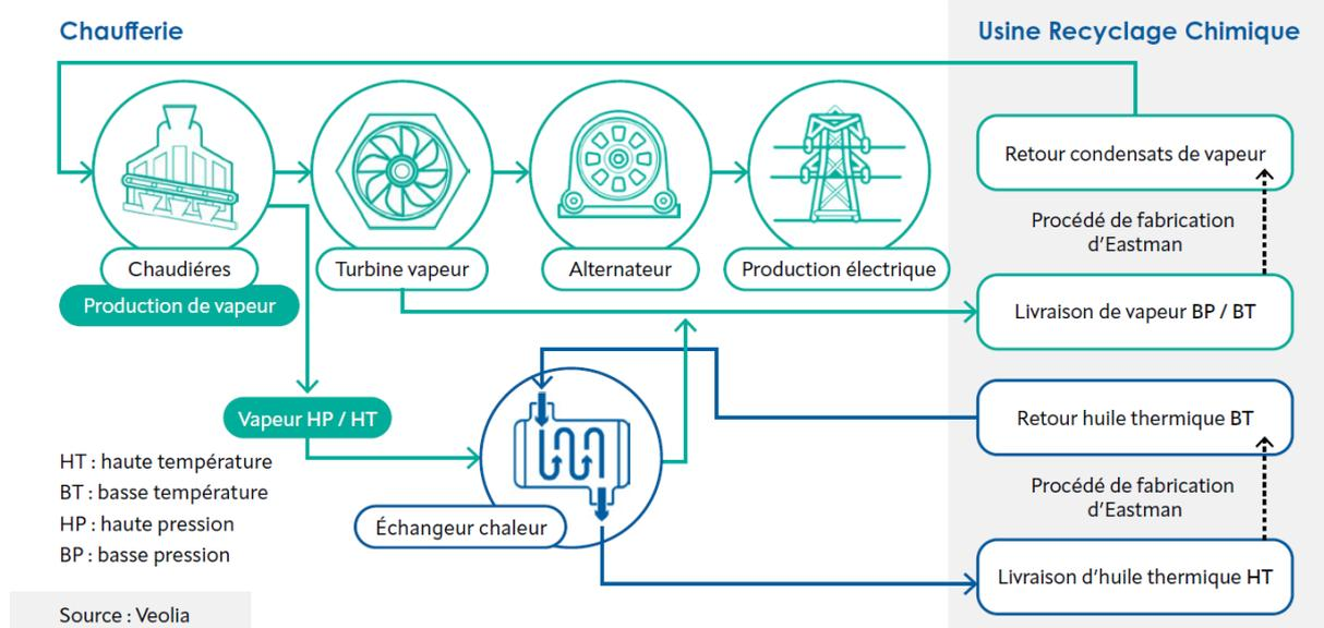
Toute la vapeur produite sera valorisée sur le site. Des tuyauteries calorifugées cheminant sur une même conduite aérienne (ou rack) entre la chaufferie et l'usine d'Eastman permettront les échanges de fluides entre les deux unités.
